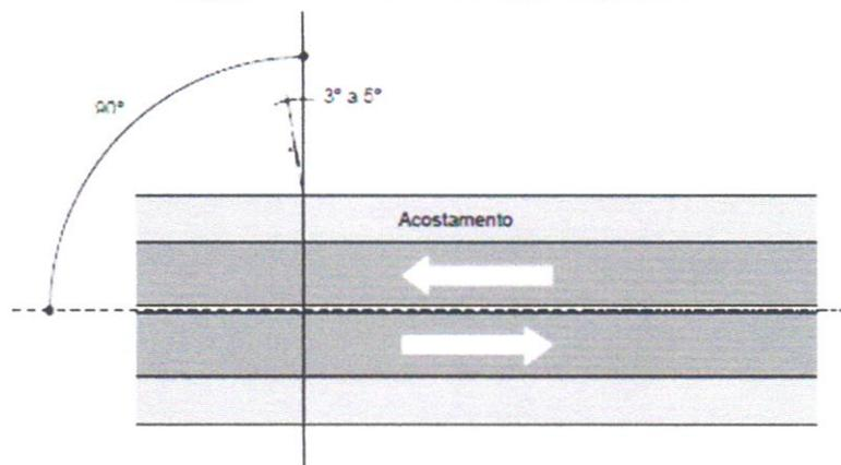
Adicionalmente, os sinais devem ser inclinados em relação à vertical, em trechos de rampa, para frente ou para trás conforme a rampa seja ascendente ou descendente, de forma a assim melhorar também a refletividade.
